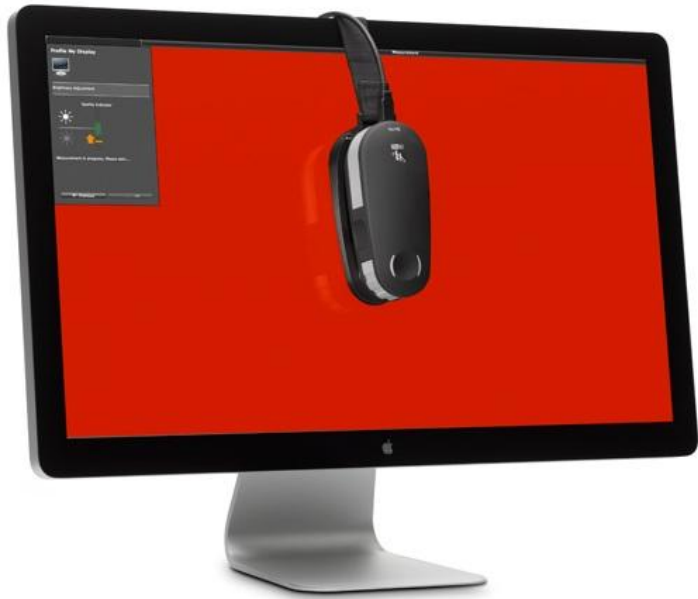
ภาพที่ 3.4 การปรับตั้งสีการแสดงผลให้เที่ยงตรงด้วยเครื่อง X-Rite i1Basic Pro 2
