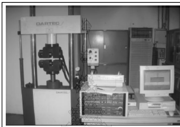
ภาพที่ 3.10 เครื่องทดสอบแรงดึงแบบ Universal Testing Machines
