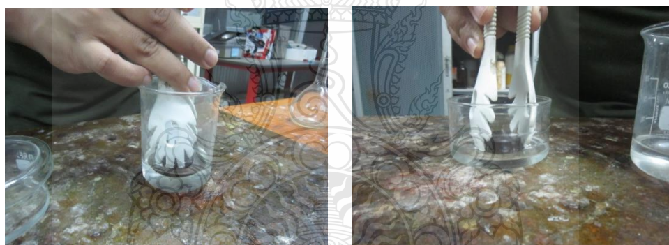
ภาพที่ 3.20 การกัดครดผิวชิ้นงานสำหรับตรวจสอบโครงสร้างจุลภาค
