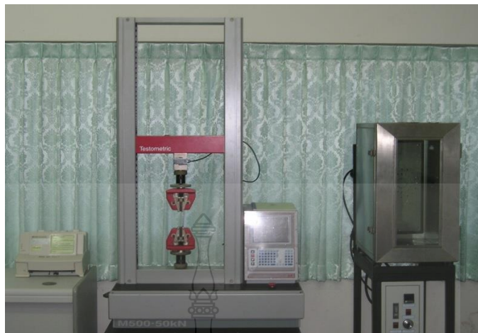
ภาพที่ 3.12 เครื่องทดสอบแรงดึง
