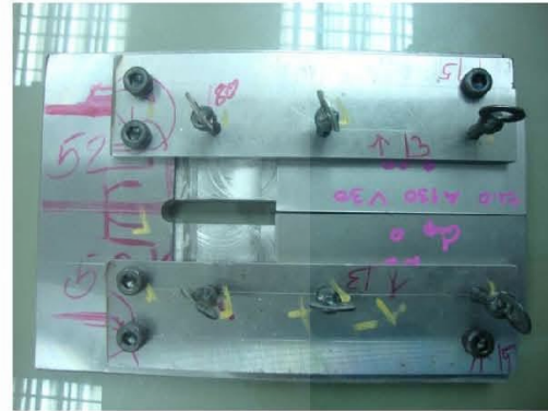
รูปที่ 1 การวางชิ้นงานบนจิ๊กเชื่อม
