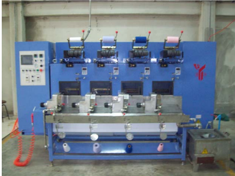
รูปที่ 3.4 เครื่องลงแปรงเส้นด้ายเดี่ยวขนาดทดลอง (single yarn sizing machine) ยี่ห้อ Jiangyin Tongyuan รุ่น GA 392
