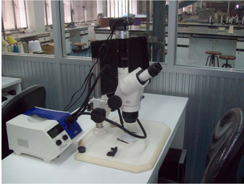
รูปที่ 3.9 กล้องจุลทรรศน์ตรวจสอบรูปร่างตามยาวของเส้นด้าย ยี่ห้อ Zeiss รุ่น Stami 2000-C
