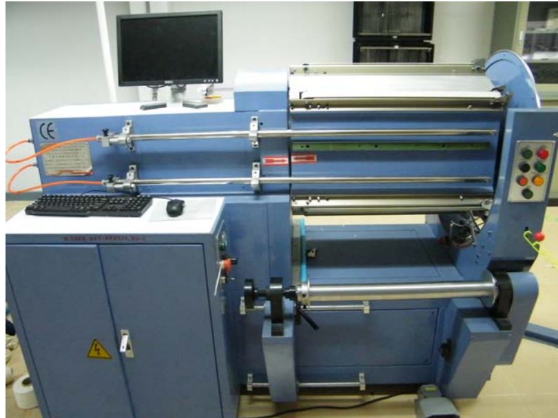
รูปที่ 3.10 เครื่องสืบเส้นด้ายยืน ยี่ห้อ Jiangyin Tongyuan รุ่น GA 193-600
