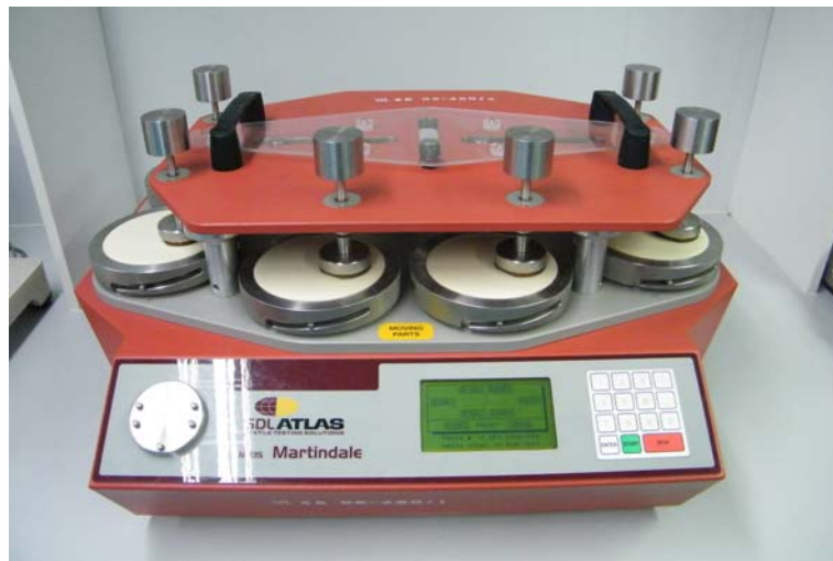
รูปที่ 3.15 เครื่องทดสอบความต้านทานการขัดถูของผ้า ยี่ห้อ SDL Atlas รุ่น M235
