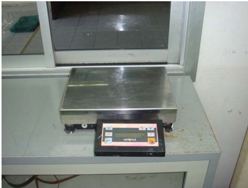
รูปที่ 3.2 เครื่องชั่งทศนิยม 1 ตำแหน่ง ยี่ห้อ Sartorius รุ่น EB15DCE-I
