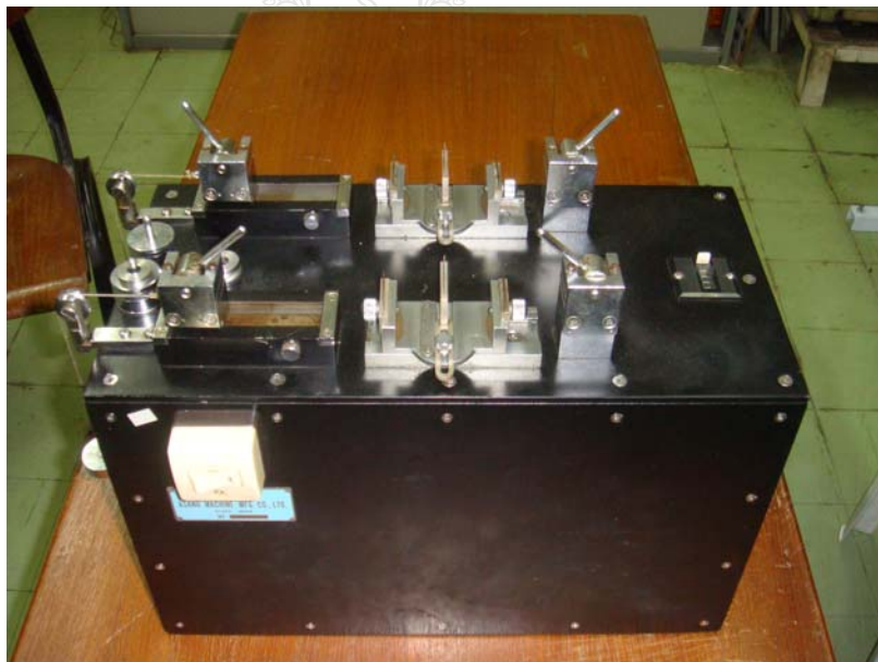
รูปที่ 3.7 เครื่องทดสอบความคงทนต่อการขัดถู (abrasion tester) ยี่ห้อ Asano
