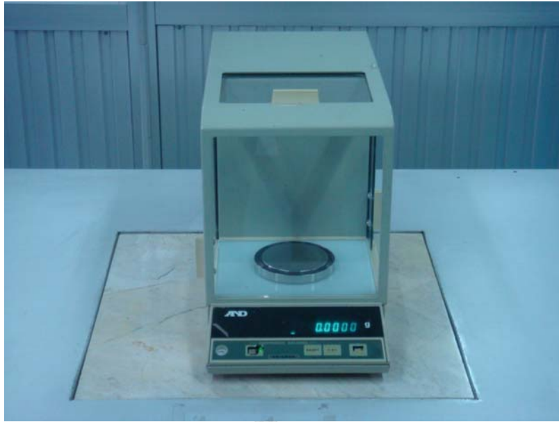
รูปที่ 3.5 เครื่องชั่งทศนิยม 4 ตำแหน่ง ยี่ห้อ A&D รุ่น ER-182A
