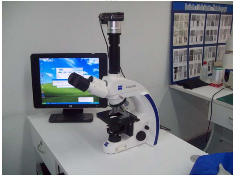
รูปที่ 3.8 กล้องจุลทรรศน์ตรวจสอบภาคตัดขวางของเส้นด้าย ยี่ห้อ Zeiss รุ่น Primo Star
