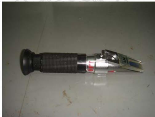
รูปที่ 3.3 เครื่องทดสอบความเข้มข้นของสารลงแป้ง (refractometer tester) ยี่ห้อ Atago รุ่น N1
