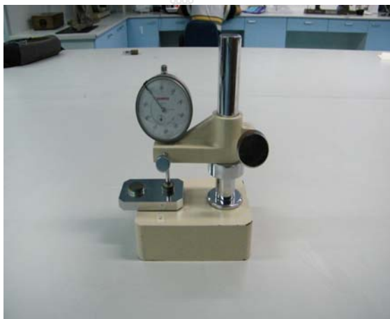
รูปที่ 3.13 เครื่องทดสอบความหนาของผ้า ยี่ห้อ PEACOCK รุ่น 207
