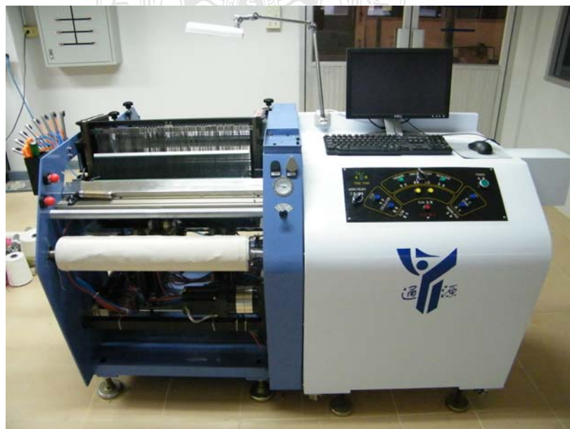
รูปที่ 3.11 เครื่องทอผ้าตัวอย่าง ยี่ห้อ Jiangyin Tongyuan รุ่น GA 598
