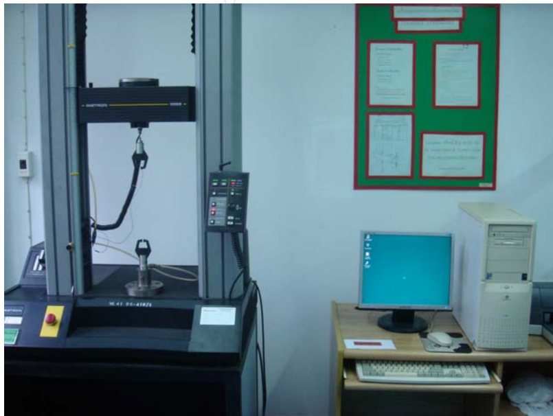
รูปที่ 3.6 เครื่องทดสอบความแข็งแรงต่อแรงดึง (tensile strength tester) ยี่ห้อ Instron รุ่น 5569
