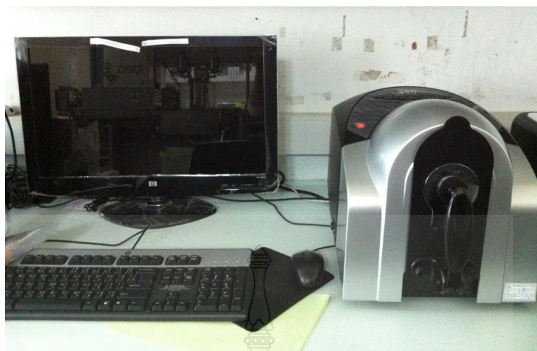
รูปที่ 3.12 เครื่องวัดค่าสี (Datacolor 650 Spectrophotometer)
