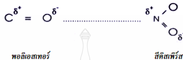
รูปที่ 2.19 แรงดึงดูดระหว่างขั้วระหว่างสตีลสเฟิร์สกับเส้นใยพอลิเอสเตอร์
