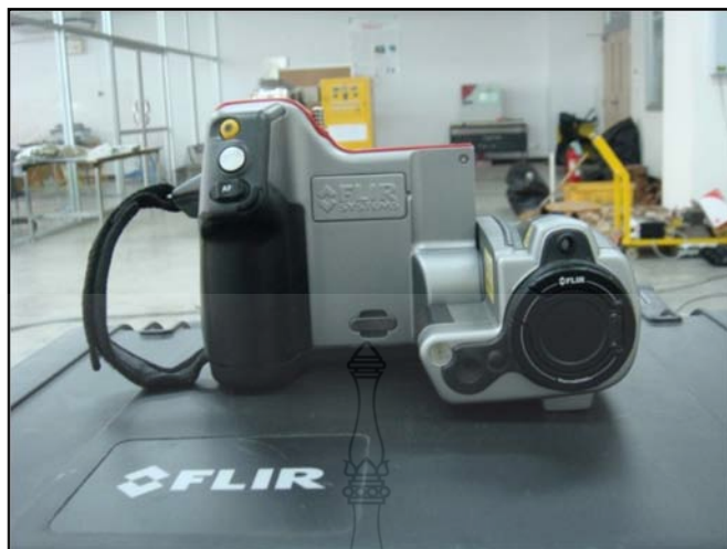
ภาพที่ 3.4 กล้องถ่ายภาพทางความร้อน (Infrared Camera)
