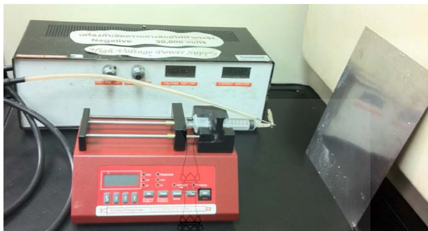
รูปที่ 3.8 ชุดปั่นเส้นใยด้วยไฟฟ้าสถิต ( Electrospinning)
