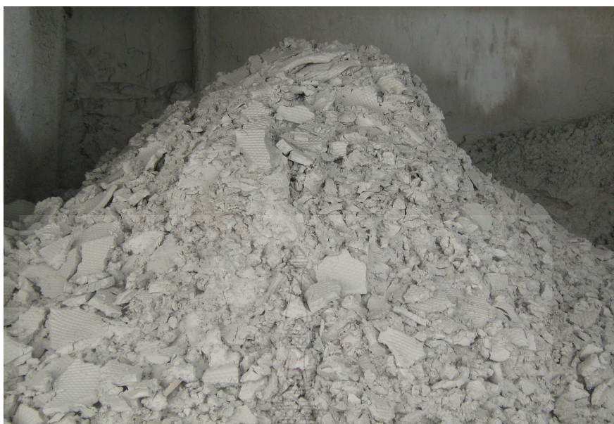
ภาพที่ 2.1 กากดินตะกอนกระเบื้องหลังคาเซรามิก
