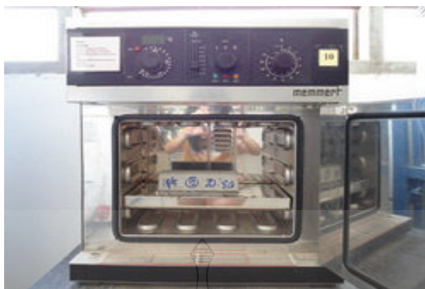
ภาพที่ 3.9 นำคอนกรีตเข้าเตาอบ
