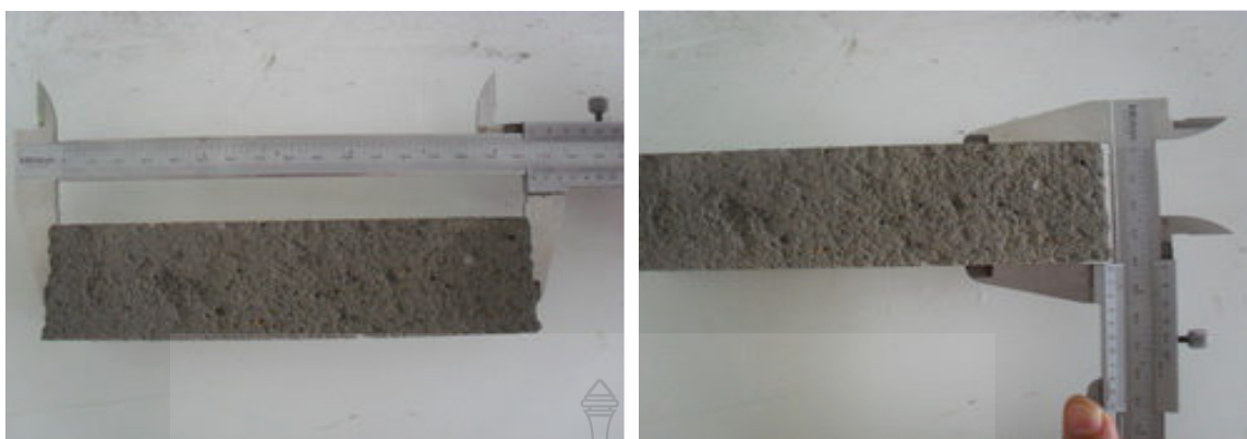
ภาพที่ 3.11 วัดขนาดแต่ละด้านของคอนกรีตหลังแช่น้ำครบ 3 วัน
