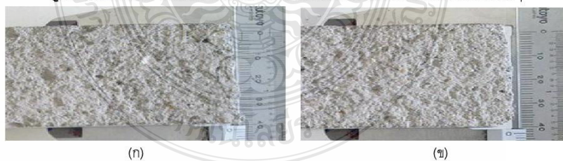
รูปที่ 5 (ก) การวัดความยาวก่อนทำการทดสอบ (ข) การวัดความยาวหลังทำการทดสอบ พบว่ามีอัตราการเปลี่ยนแปลงความยาวเพียงเล็กน้อย
