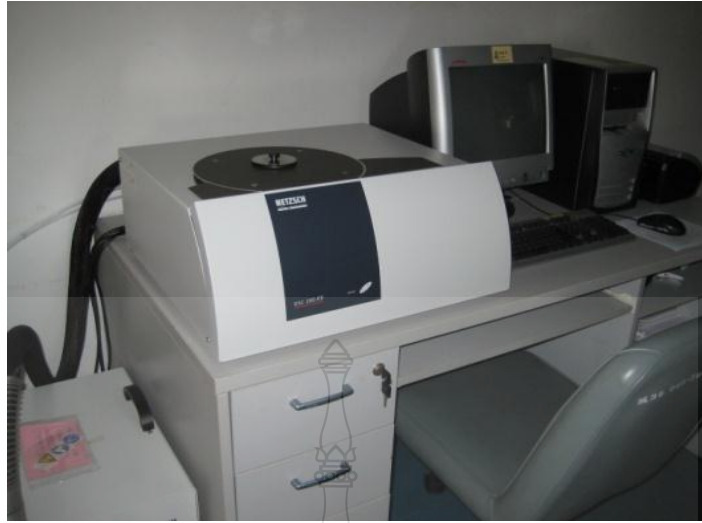
รูปที่ 3.10 เครื่องทดสอบดิฟเฟอเรนเชียลสแกนนิ่งแคลอริมิเตอร์ (Differential Scanning Calorimeter, DSC)
