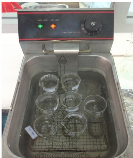
รูปที่ 3.11 เครื่องทดสอบสมบัติการหดตัวของเส้นใย (%Shrinkage)
