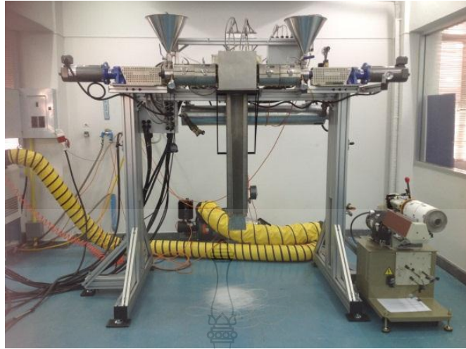
รูปที่ 3.8 เครื่องขึ้นรูปเส้นใยสององค์ประกอบ (Hills:Lab Scale Bicomponent Extruder Fed Spinning Machine)
