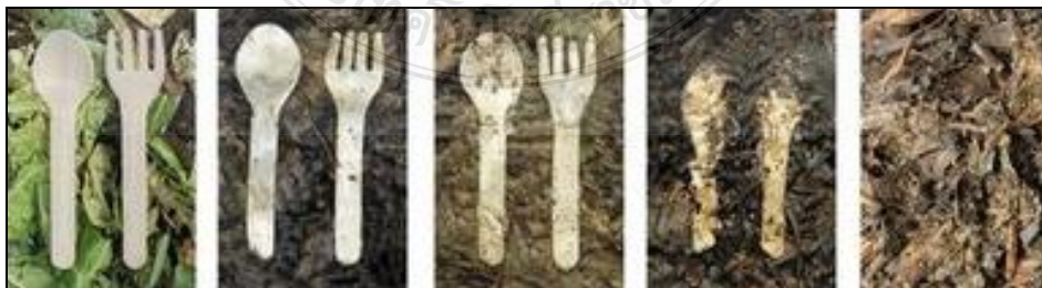
รูปที่ 2.5 ลักษณะการย่อยสลายของพอลิแลคติกแอซิดที่เกิดขึ้น [7]
