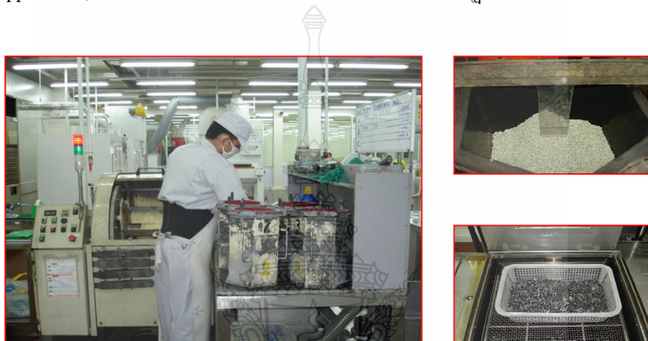
ภาพที่ 3.6 กระบวนการขัดหยาบ (Barreling Process)
