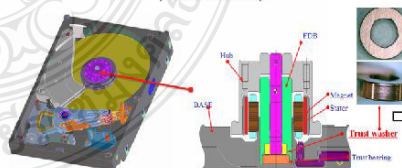
รูปที่ 2 แสดง Thrust washer เข้ากับส่วนประกอบของมอเตอร์ฮาร์ดดิสก์ไทร์ฟ
