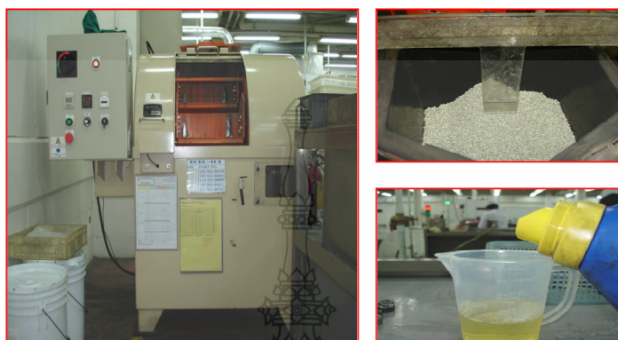
ภาพที่ 3.11 กระบวนการขัดหยาบ (Barreling Process)
