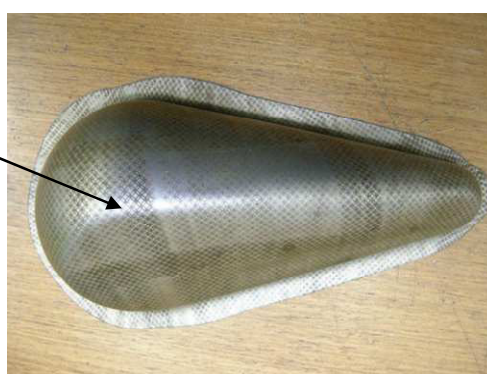
ภาพที่ 4.8 ชิ้นงานสำเร็จจากการขึ้นรูปของแผ่นตัดเปล่าคำนวณโดยการประมาณค่าเพื่อวิเคราะห์ผล
