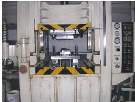
รูปที่ 5 แม่พิมพ์บนเครื่องปัมไฮดรอลิก
