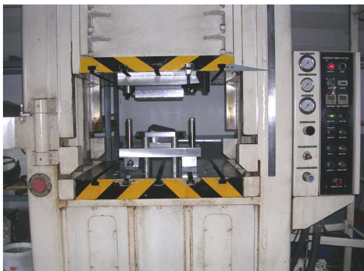
ภาพที่ 3.9 ประกอบสายและพื้นชั้นบนแทนเครื่องปั๊มไฮดรอลิกในการขึ้นรูปขึ้นงาน
