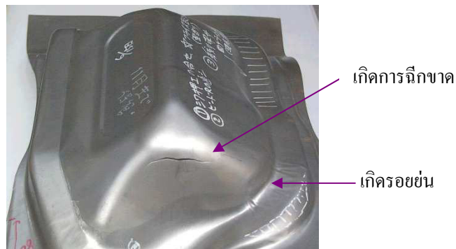
ภาพที่ 2.4 ตัวอย่างของชิ้นงานที่ขึ้นรูปแบบไม่สมมาตรและพื้นที่เกิดความบกพร่อง [8]
