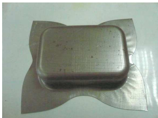
ภาพที่ 2.3 ชิ้นงานขึ้นรูปทรงกระบอกสี่เหลี่ยม
