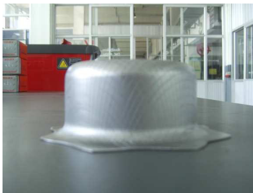
ภาพที่ 2.2 การขึ้นรูปลึงด้วยทรงกระบอก
