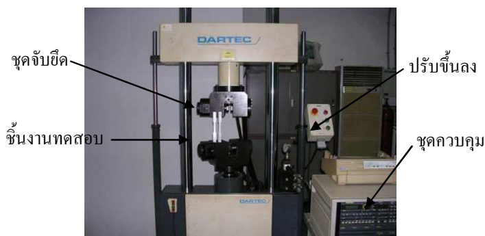
ภาพที่ 3.2 เครื่องทดสอบแรงดึง (Tensile Test) [2]
