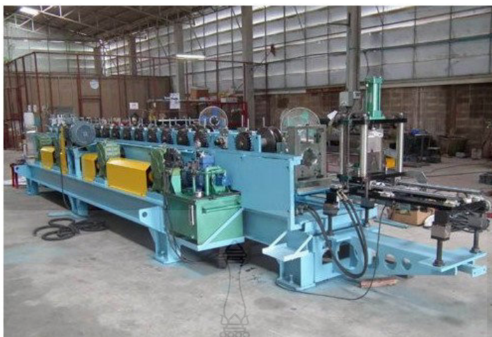
ภาพที่ 3.7 เครื่องรีดแปดสำเร็จรูป
