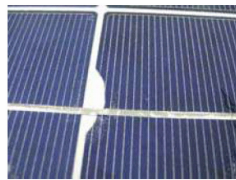
รูปที่ 13 ตัวอย่างเซลล์แตกในขั้นตอนลามิเนต
