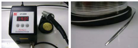
(ก) หัวแรงไฟฟ้า (ข) ลวดตัวนำไฟฟ้า
