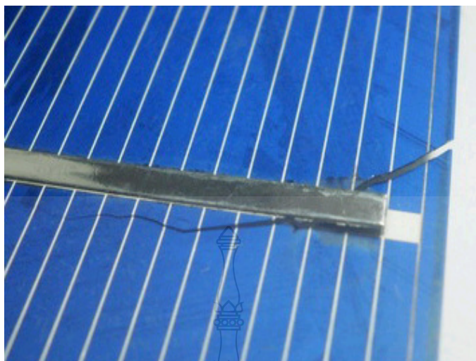
ภาพที่ 4.5 เซลล์แตกในขั้นตอนเชื่อมต่อเซลล์ที่อุณหภูมิ 400 องศาเซลเซียส เวลา 6 วินาที และ รับบอนขนาด 0.20×2.00 มิลลิเมตร
