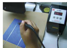
รูปที่ 5 ขั้นตอนเชื่อมต่อเซลล์แบบบั้ง (Tabbing)
