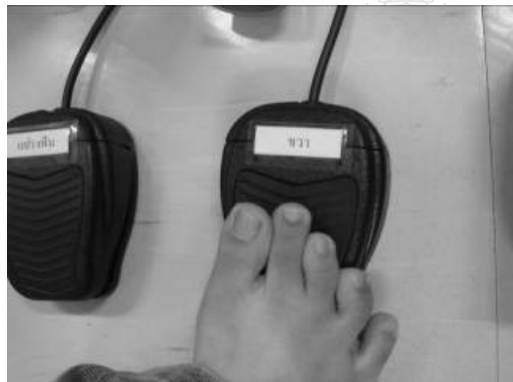
รูป ก.15. เลือกปุ่ม “M1” และเขี่ยบปุ่ม “Foot SW ขวา” เพื่อแปรงสีฟันด้านขวา
