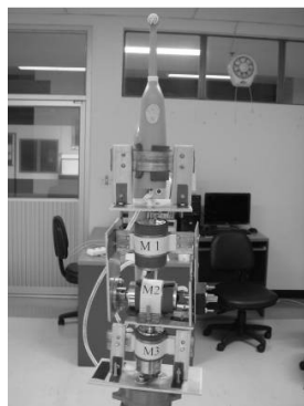
รูป ก.18. ทำการจัดตำแหน่งมอเตอร์และแปรงให้หันหน้าและตั้งตรงดั้งเดิมเลือกปุ่ม “Power” เป็นการจบการทำงาน
