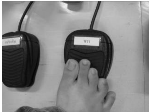
รูป ก.12. การเหยียบปุ่ม“Foot SW ขวา” เพื่อให้แปรงหงายไปด้านหลังให้แปรงพอดีกับหลอดยาสีฟันที่เตรียมไว้
