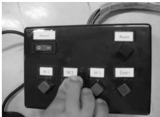
รูป ก.8. การเหยียบปุ่ม “M2” (LED 2 ติด) เพื่อเลือกการทำงานของมอเตอร์ตัวที่ 2
