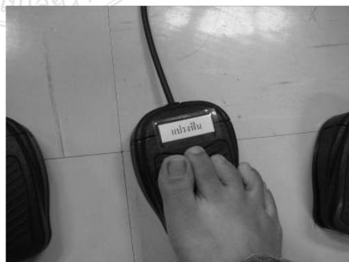
รูป ก.16. เขี่ยบปุ่ม “Foot SW แปรงฟัน” เพื่อเปิดการทำงานของแปรงสีฟัน
