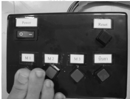
รูป ก.7. การเหยียบปุ่ม “M1” (LED 1 ติด) เพื่อเลือกการทำงานของมอเตอร์ตัวที่ 1
