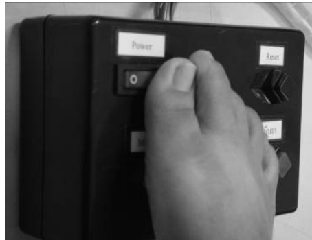
รูป ก.6. การเปิดปุ่ม “Power” ดูสถานะ การทำงานของมอเตอร์จากหลอด LED หากยังไม่มี การเลือก LED จะติดหมด
