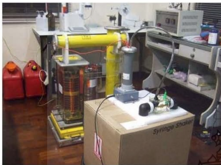
รูปที่ 3 วงจรจริงที่ใช้ทดสอบดิสชาร์จบางส่วนในน้ำมันหม้อแปลง
