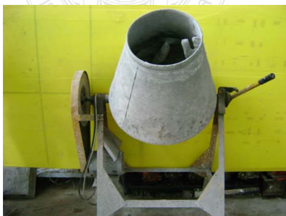
รูปที่ 3.5 เครื่องผสมคอนกรีต
