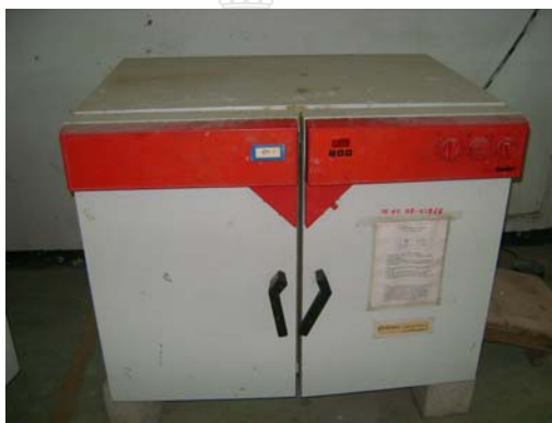
รูปที่ 3.7 ตู้อบที่สามารถควบคุมความร้อนที่อุณหภูมิ 110 \pm 5 องศาเซลเซียส
