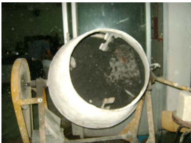
รูปที่ 3.11 การผสมเถ้ากลบ ททราย และปูนซีเมนต์ให้เข้ากัน
