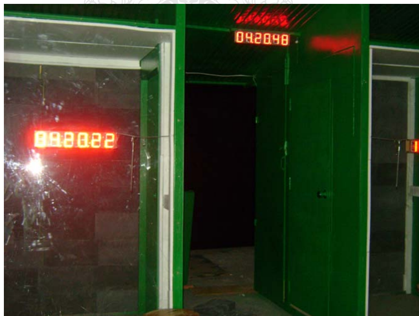
รูปที่ จ.4 การทดสอบอุณหภูมิของผนังอิฐบล็อกที่ไม่เสริมแผ่นยางพาราและเสริมแผ่นยางพารา
