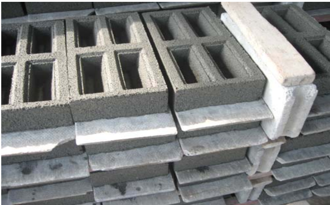
รูปที่ 2.14 ตัวอย่างของบล็อกชนิด Screen Block
