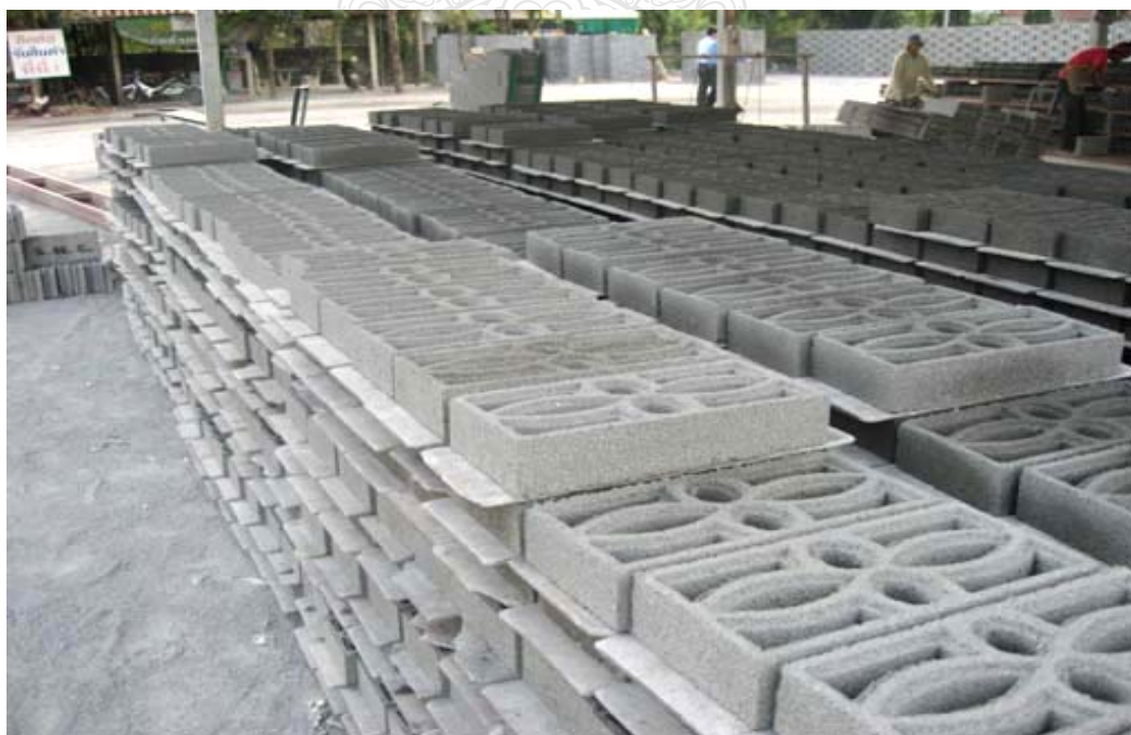
รูปที่ 2.15 ตัวอย่างของบล็อกชนิด Screen Block ประเภทต่าง ๆ
