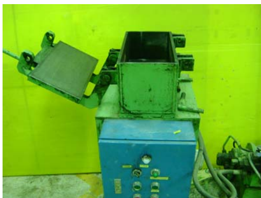
รูปที่ 3.8 เครื่องอัดบล็อกไฮดรอลิกที่สามารถอัดบล็อกขนาด 190 \times 390 \times 70 มิลลิเมตร
