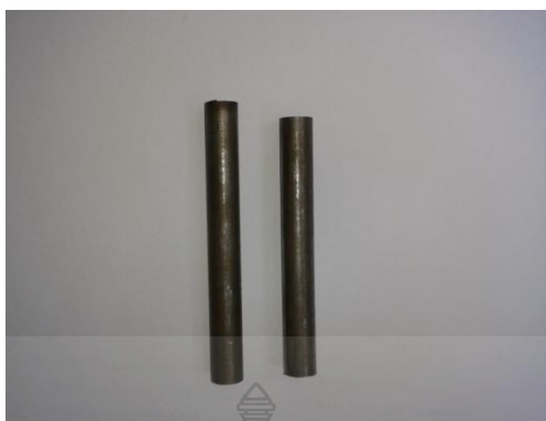
ภาพที่ 3.5 เหล็กกล้า AISI 1045 ขนาด 10 x 100 มิลลิเมตร
