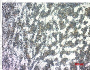
ง. โครงสร้างระหว่างแนวรอยเชื่อมกับชิ้นงานหลักด้านขวา
