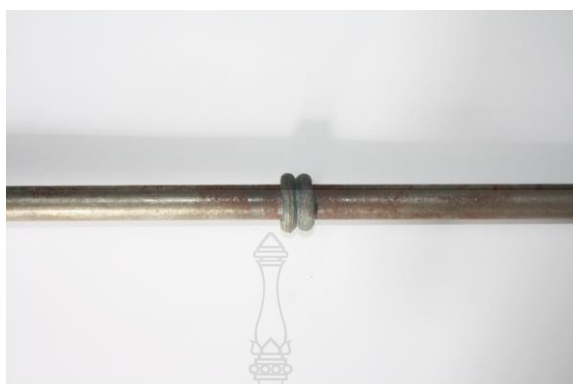
ภาพที่ ก.7 ชิ้นงานที่ทำการเชื่อมด้วยความเสียดทานที่เวลา 4 วินาที ความดัน 20 บาร์
