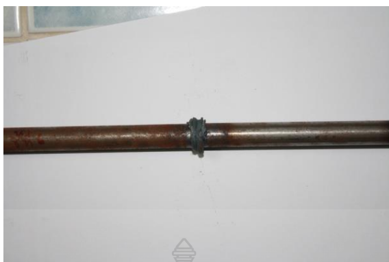
ภาพที่ ก.1 ชิ้นงานที่ทำการเชื่อมด้วยความเสียดทานด้วยความเร็วรอบ 1,500 รอบ/นาที เวลา 2 วินาที ความดัน 20 บาร์
