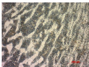
ค. โครงสร้างระหว่างแนวรอยเชื่อมกับชิ้นงานหลักด้านซ้าย
