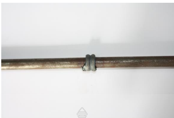
ภาพที่ ก.10 ชิ้นงานที่ทำการเชื่อมด้วยความเสียดทานที่เวลา 2 วินาที ความดัน 30 บาร์
