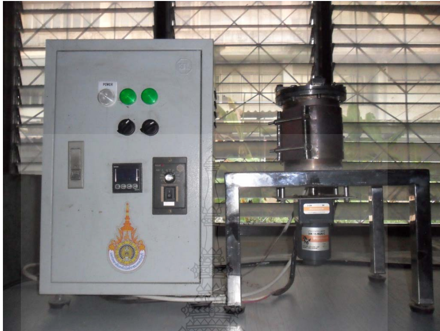
รูปที่ 3.22 การประกอบตั้งปฏิกิริยาเข้ากับชุดให้ความร้อนและชุดกวนสาร
