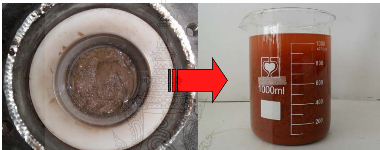
รูปที่ 4.12 ภาพตัวอย่างที่สังเคราะห์ผ่านกระบวนการไฮโดรเทอร์มอลโดยใช้อุณหภูมิ 105 °C เป็นเวลา 24 ชั่วโมง ใช้สารละลาย NaOH ที่มีความเข้มข้น 10 M
