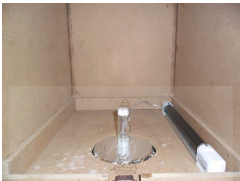
รูปที่ 3.17 แหล่งกำเนิดแสงอัลตราไวโอเล็ต (UV)
