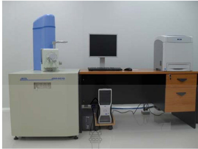
รูปที่ 2.74 กล้องจุลทรรศน์อิเล็กตรอนแบบส่องกราด (SEM)
