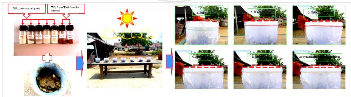
รูปที่ 2 การทดลองนำไปใช้งานเป็นตัวเร่งปฏิกิริยาโดยใช้แสงในการผลิตก๊าซจากมูลสัตว์ท่อนานจากแร่โอลิเมนที่เปรียบเทียบกับ \text{TiO}_2 เจริงพาณิชย์
