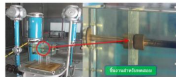
รูปที่ 5 การทดสอบฉนวนแรงดันขึ้นต่อความทนแรงดันไฟฟ้า
