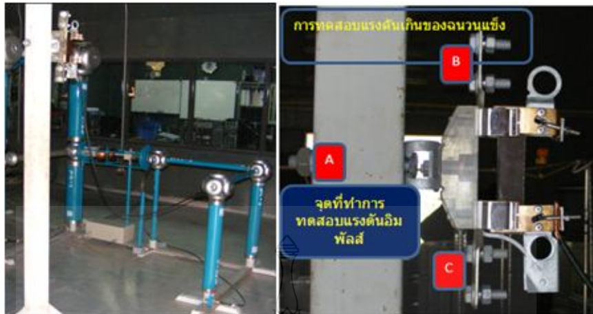
รูปที่ 4.8 วงจรทดสอบความคงทนต่อแรงดันอิมพัลส์ฟ้าผ่า 1.2/50 \mu s
