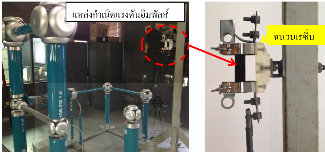
รูปที่ 4.4 การจัดวางอุปกรณ์การทดสอบความคงทนต่อแรงดันอิมพัลส์เบรคดาวน์
