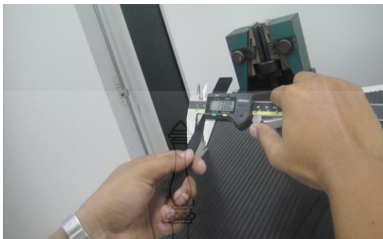
รูปที่ 3.8 การวัดขนาดชิ้นงานทดสอบความทนทานต่อแรงดึง
