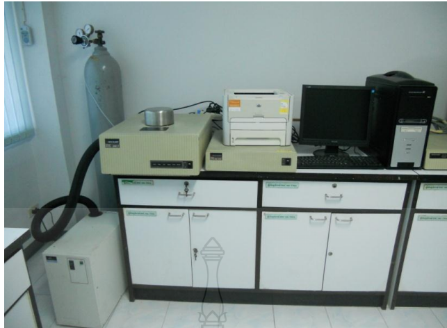
รูปที่ 2.20 เครื่องทดสอบสมบัติทางความร้อน DSC
