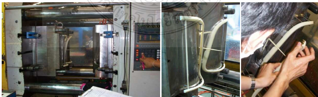
ภาพที่ 4.12 การทดลองฉีดพลาสติกชิ้นส่วนตัวอย่างกรณีศึกษา
