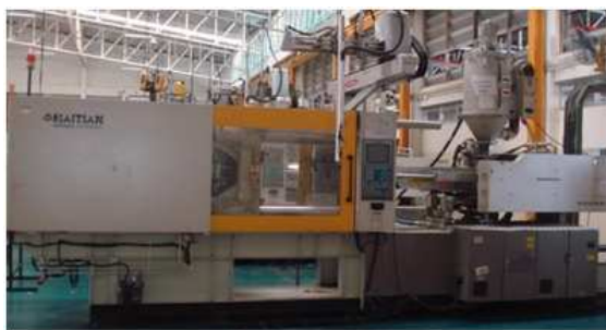
ภาพที่ 3.10 เครื่องฉีดพลาสติกที่ใช้ในกระบวนการฉีดขึ้นส่วนตัวอย่างกรณีศึกษา
