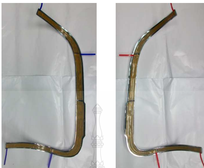
ภาพที่ 3.19 ลักษณะชิ้นส่วนที่ผ่านกระบวนการตีเทปกาว 2 หน้า
