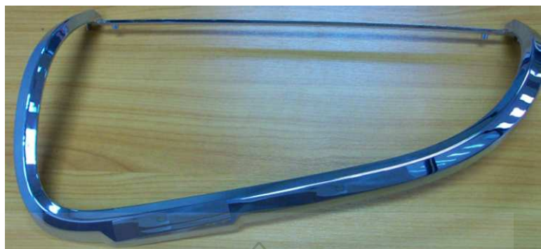
ภาพที่ 3.18 ลักษณะการหุบเคลือบผิวด้วยโครเมียมบนชิ้นส่วนตัวอย่างกรณีศึกษา
