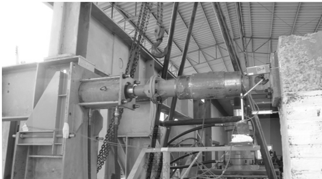
ภาพที่ ก.21 ชุดให้แรงกระทำทางด้านข้าง ไฮดรอลิกส์แจ๊คต่อกับ Load Cell
