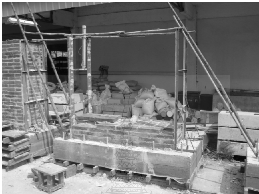
ภาพที่ ก.1 เตรียมผนังอิฐก่อโบราณตัวอย่างทดสอบ
