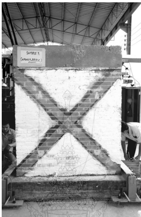
ภาพที่ ก.44 ผนัง AMW03_GFRP.C หลังการทดสอบ เกิดรอยร้าวรอบผนังบริเวณสูงจากฐานคอนกรีตเสริมเหล็กประมาณ 30 ซม.
