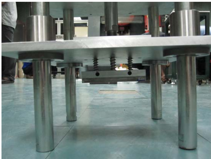
รูปที่ 3.11 แสดงการติดตั้งชุดแผ่นเพลทเลื่อนขึ้นลงได้ (Slide plate)
