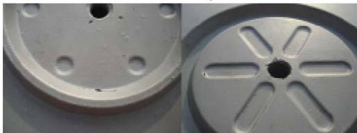
b) ลักษณะการเสียหายของชุดอินเล็ต 60:40
