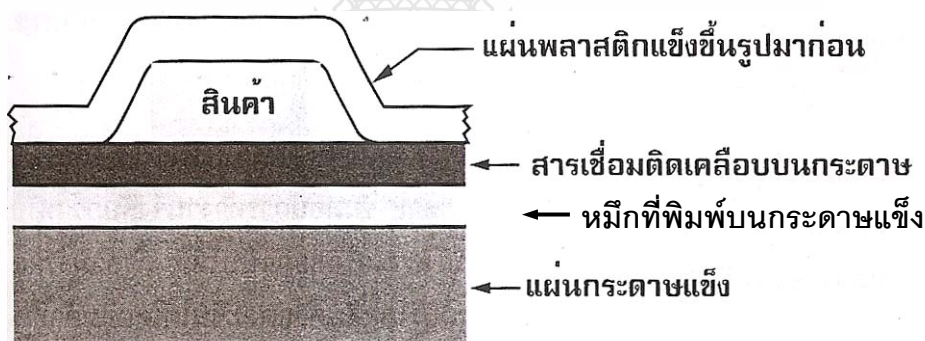
รูปที่ 2.1 การขึ้นรูปของบรรจุภัณฑ์การ์ดแบบบลิสเตอร์ [5]
