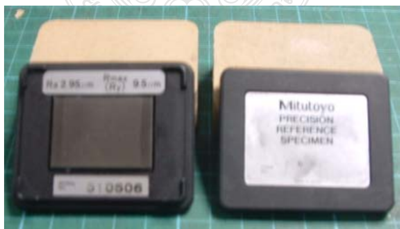
รูปที่ภาคผนวก ค.2 ซินททดสอบวัดเปรียบเทียบค่าความเรียบผิวมาตรฐาน
