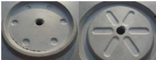
a) ลักษณะการเสียหายของชุดอินเล็ต 70:30
