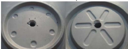
c) ลักษณะการเสียหายของชุดอินเล็ต 50:50
