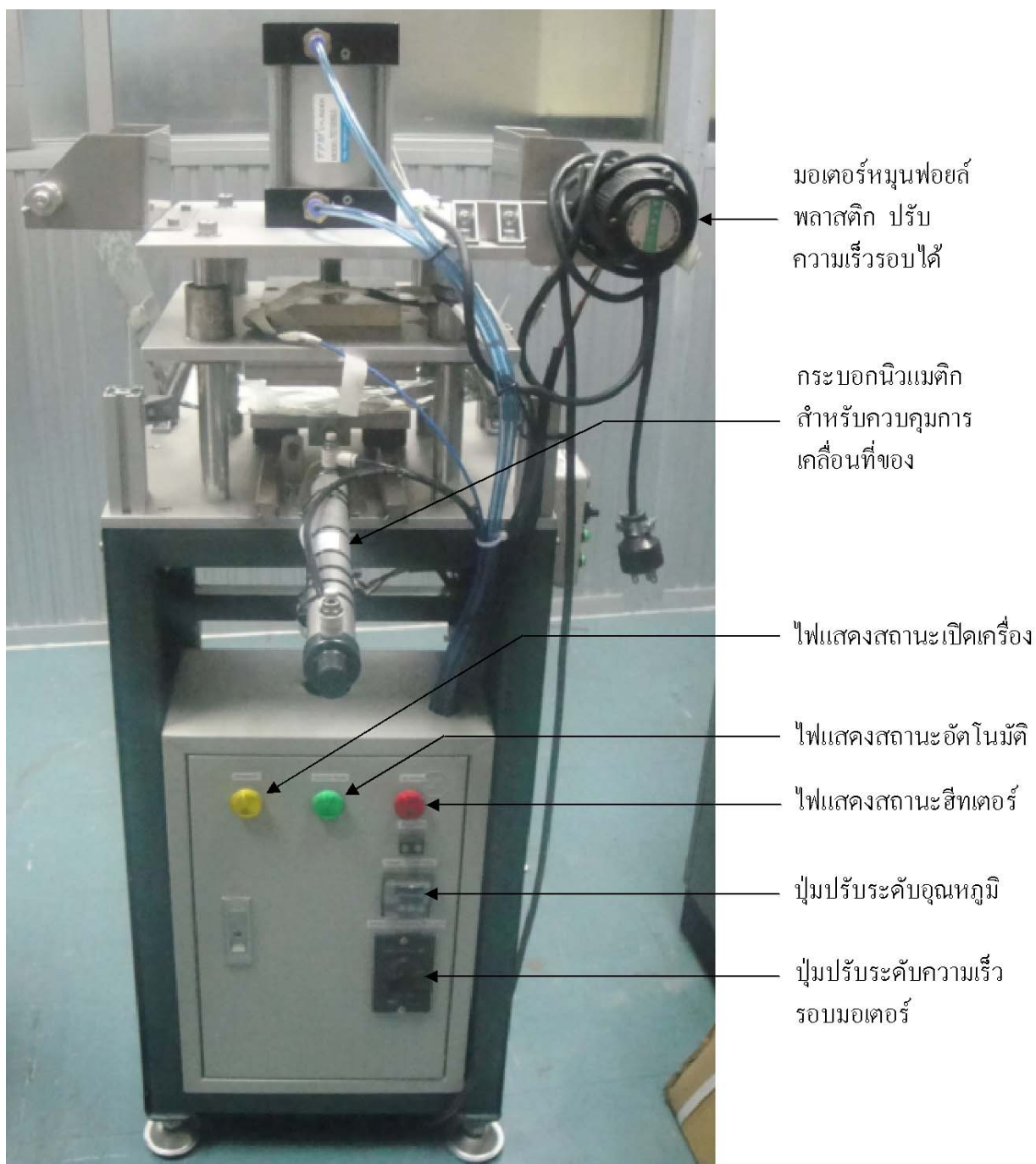
รูปที่ 4.2 แสดงส่วนประกอบต่างๆของเครื่องสร้างบรรจุภัณฑ์ปลาร้าก้อนแบบบลิสเตอร์แพ็ค (ด้านหลัง)
