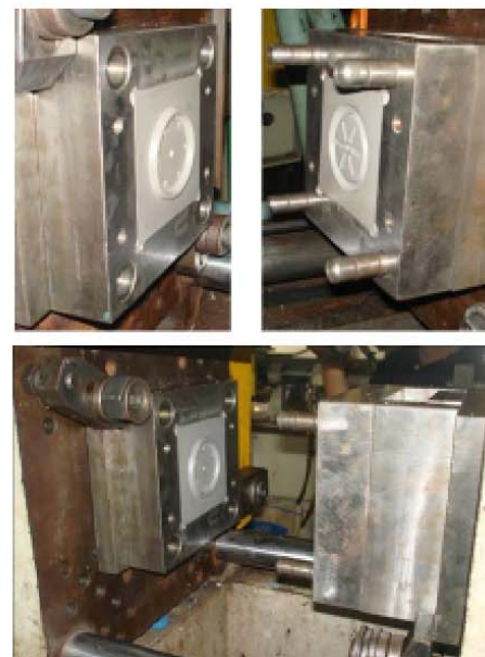
รูปที่ 7 การติดตั้งแม่พิมพ์ฉีดบนเครื่องฉีด TOYO รุ่น TI-50E
