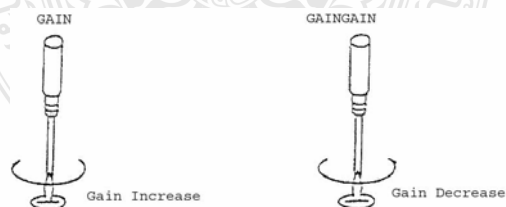
รูปที่ภาคผนวก ค.10 การปรับค่าการวัดของหัววัด โดยใช้ไขควง
