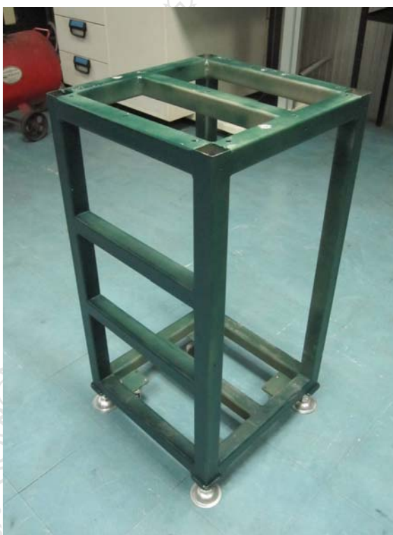
รูปที่ 3.6 แสดงโครงเครื่องหลังจากทำการเชื่อมและฟันสี
