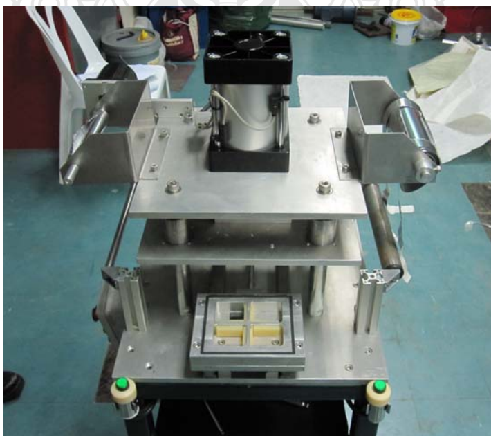
รูปที่ 3.12 แสดงการติดตั้งติดตั้งชุดม้วนฟอยด์อะลูมิเนียม
