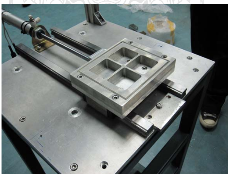
รูปที่ 3.8 แสดงการติดตั้งชุดตัวนำร่องเลื่อนเข้ากับจิกรองรับพร้อมกระบอบอกสูบ
