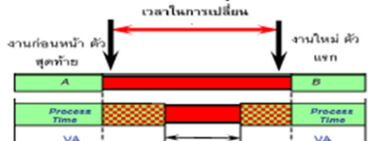
รูปที่ 10 แผนภูมิแสดงการทำงานของคนกับเครื่องจักร ปัญหาที่เป็นปัญหาหลัก 6 อันดับที่ต้องทำการแก้ไขเพื่อลดเวลาในการทำการกิจกรรมการหยิบงานเข้าและออกจากเครื่องขัดได้แก่ ปัญหาการว่างงาน 41.5% ปัญหาการเตรียมงาน 19.4%
