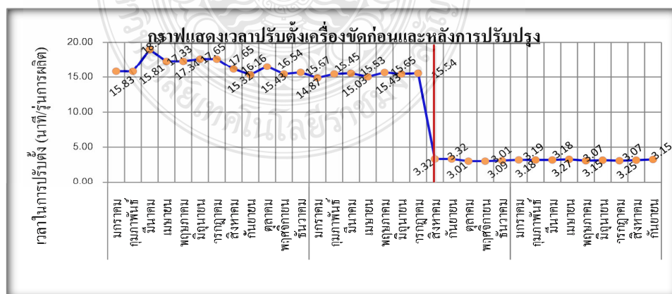
ภาพที่ 4.23 เวลาการปรับตั้งเครื่องจักรก่อนและหลังการปรับปรุง
