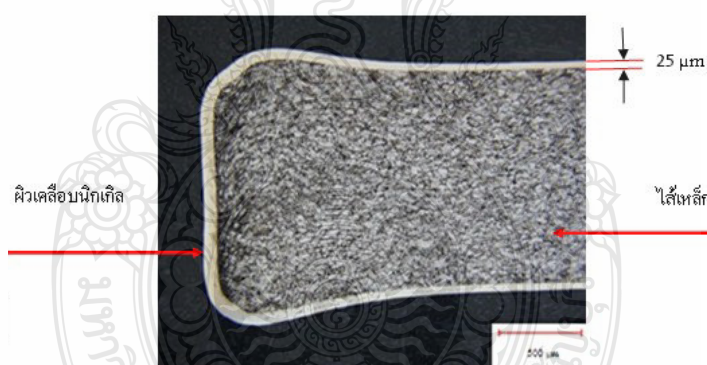
ภาพที่ 2.8 ภาพตัดขวางโลหะเหรียญตัวเปล่าชนิดราคา 1 บาท [26]
