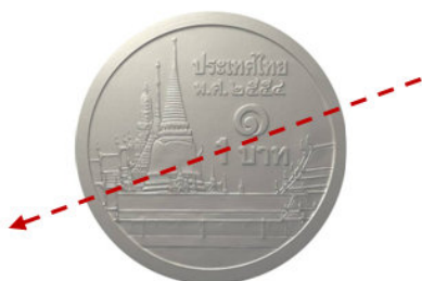
ภาพที่ 2.1 แนวการลากผ่านวัดโค้งกระทะ (Curvature) และความสูงลดตายแม่พิมพ์ด้านก้อย [1]
