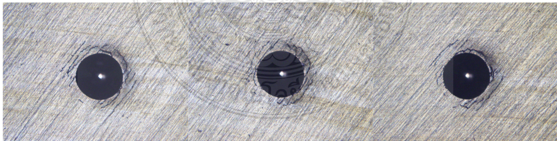
(ข) แสดงรอยกดบนผิวเคลือบ TiN จำนวน 3 จุด ในการทดสอบตามมาตรฐาน VDI 3198
