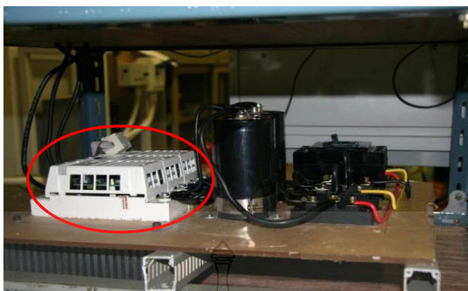
ภาพที่ 3.14 ชุดคอนเวอร์เตอร์กำลังด้านกริดระบบ
