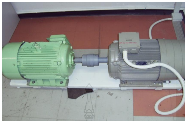
ภาพที่ 4.3 การติดตั้งเครื่องกำเนิดไฟฟ้าเข้ากับมอเตอร์ต้นกำลัง
