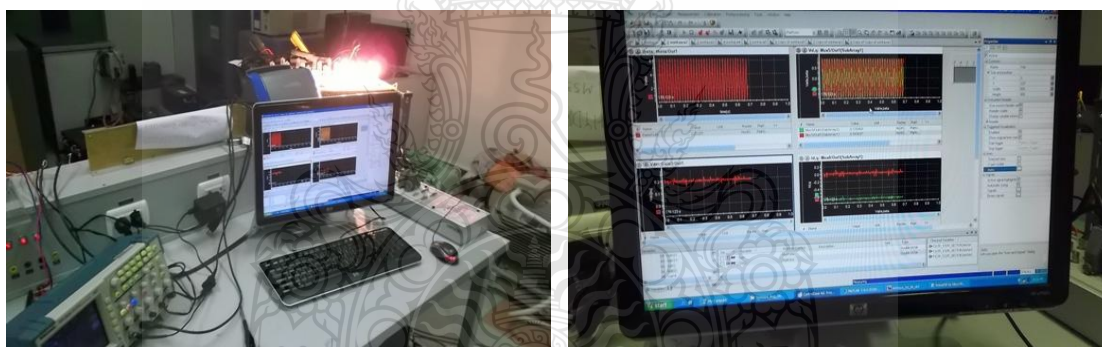
ภาพที่ 3.30 ควบคุมการทำงานของวงจรผ่านโปรแกรมดิสเปซ และบอร์ด DS1104
