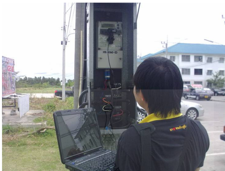
ภาพที่ 4.17 การใช้เทคโนโลยีประมวลผลภาพประเมินผลความถูกต้องเครื่องวัดพลังงานไฟฟ้าแบบอิเล็กทรอนิกส์ผลิตภัณฑ์ Actaris
