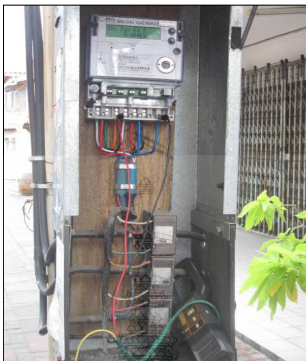
ภาพที่ 4.8 การวัดกำลังไฟฟ้าจริงเฟส B ด้วยแคลมป์ออนเพาเวอร์มิเตอร์
