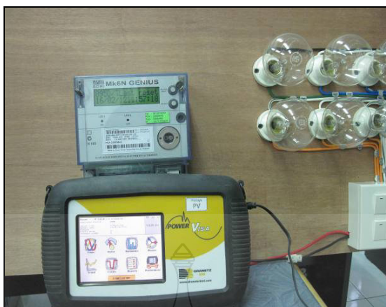
ภาพที่ 3.14 การทดสอบการทำงานของหลอด LED1
