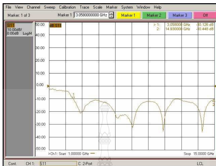
ภาพที่ 4.5 การทดสอบค่าสูญเสียจากการย้อนกลับของสัญญาณของสายอากาศรูปทรงสี่เหลี่ยม ปรับจูนระดับโวลต์รีวโค้ง
