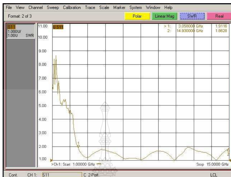
ภาพที่ 4.8 ค่าอัตราส่วนคลื่นนิ่งที่วัดได้จากสายอากาศที่ปรับจูนแบบสลับโพลครูปรีเว้าโค้ง
