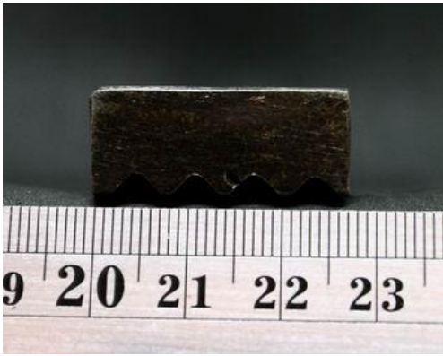
รูปที่ 3 ลักษณะรางปล่อยเมล็ดข้าวแบบเรียบ (ด้านบน)และแบบร่อง (ด้านล่าง)
