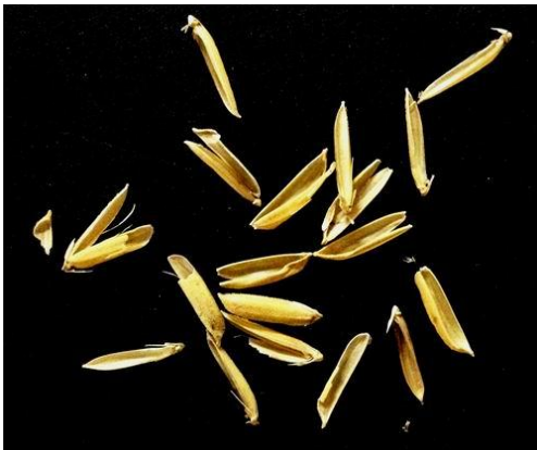
รูปที่ 1 ลักษณะแกลบที่ได้รับหลังจากการกะเทาะเปลือกด้วยเครื่อง กะเทาะเปลือกแบบลูกยางคู่
