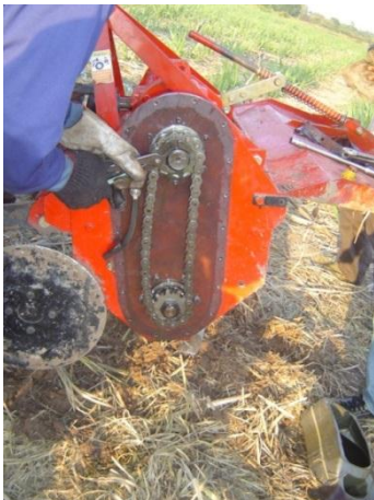
ภาพที่ 3 การทดลองสลับเปลี่ยนเฟืองในห้องโซ่
