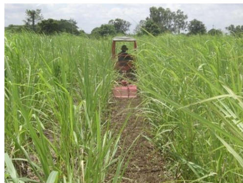
ภาพที่ 4 ทดสอบจอบหมุนสับกลบใบอ้อยติดพ่วงรถแทรกเตอร์ขนาด 24 แรงม้า
