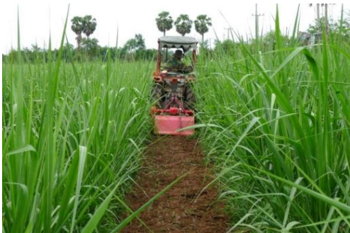
ภาพที่ 5 ทดสอบจอบหมุนกำจัดวัชพืชติดพวงรถแทรกเตอร์ขนาด 24 แรงม้า
