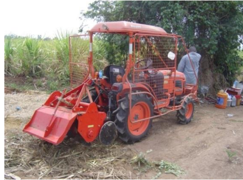
ภาพที่ 2 ต้นแบบจอบพุ่มสับกลบใบอ้อยสำหรับรถแทรกเตอร์ 24 แรงม้า
