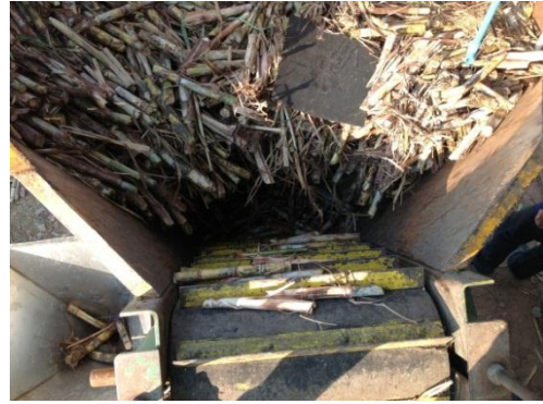
รูปที่ 5 การอัดตัวของท่อนอ้อยภายในถังบรรจุของเครื่องปลูกอ้อยชนิดโรยท่อนพันธุ์
