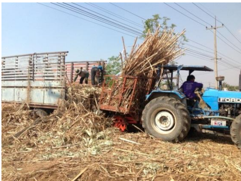
รูปที่ 3 การขนย้ายท่อนพันธุ์ใส่เครื่องปลูกแบบป้อนเป็นลำ
