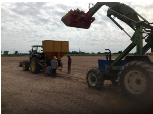
รูปที่ 4 การขนย้ายท่อนพันธุ์ใส่เครื่องปลูกแบบโรยท่อนพันธุ์
