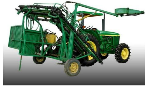
รูปที่ 5 รถตัดอ้อยแบบเป็นลำ
