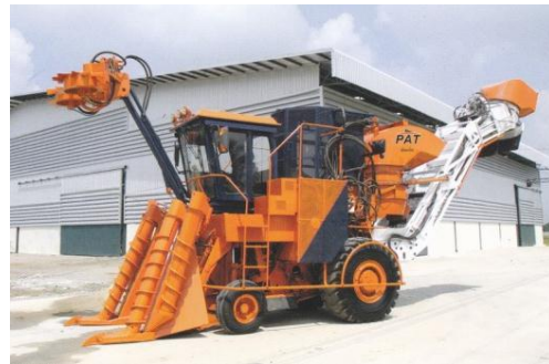
รูปที่ 6 รถตัดอ้อยแบบเป็นท่อน
