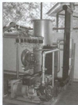
รูปที่ 1 ต้นแบบเครื่องยนต์แก๊สซิฟิเคชันขนาด 1 กิโลวัตต์
