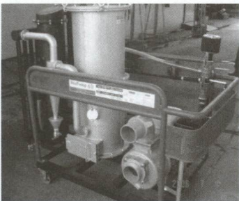
รูปที่ 6 เครื่องยนต์-แก๊สซิฟิเออร์สูบน้ำอัตรา 40 ลูกบาศก์เมตรต่อชั่วโมงต้นแบบผลิตเชิงพาณิชย์ผลิต
