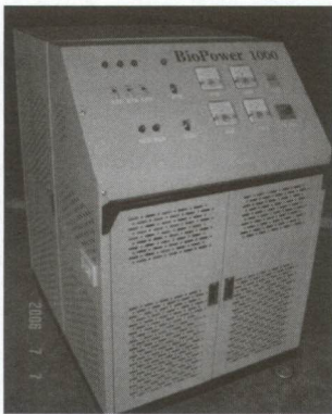
รูปที่ 5 เครื่องยนต์-แก๊สซิฟิเออร์ผลิตไฟฟ้า 1 กิโลวัตต์ ต้นแบบผลิตเชิงพาณิชย์
