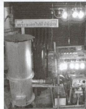
รูปที่ 3 เครื่องยนต์-แก๊สซิฟิเออร์ผลิตไฟฟ้า 1 กิโลวัตต์
