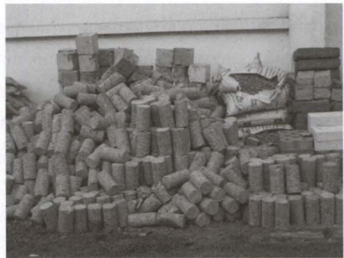
รูปที่ 2 ก้อนตัวอย่างคอนกรีตที่ผ่านการทดสอบแล้ว (ต่อ)
