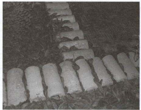
รูปที่ 9 การใช้แท่งตัวอย่างคอนกรีตปูพื้นทางเดินในสวน
