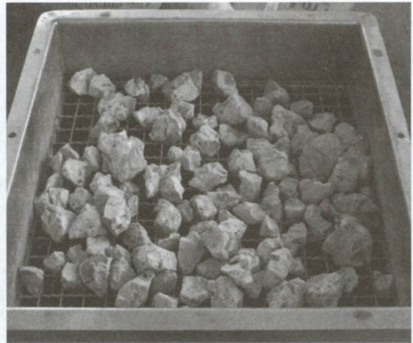
รูปที่ 3 มวลรวมหยาบที่ได้จากแท่งตัวอย่างคอนกรีต
