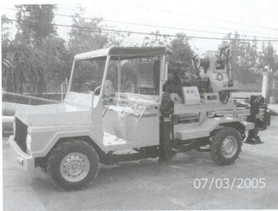
รูปที่ 4 เครื่องเจดาดำรงดินแบบหัวหมุน โดยระบบขับเคลื่อนที่ประกอบติดตั้งเสร็จเรียบร้อย
