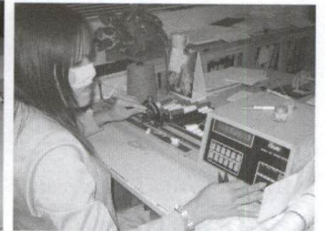
รูปที่ 15. การทดสอบจำนวนเกลียวต่อนิ้วในเส้นด้ายด้วยเครื่อง Micro Processor Twist Tester
