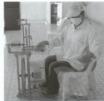
รูปที่ 10. การปั่นด้ายจากขนสุนัขด้วยเครื่องปั่นด้ายเมดเคลริจกรา
