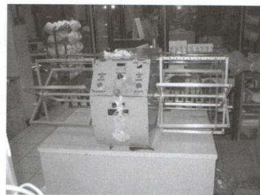
รูปที่ 16. เครื่องระวิงกรอผ้า (Warp Reel)
