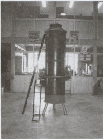
รูปที่ 1 แสดงเตาผลิตก๊าซชนิด downdraft
