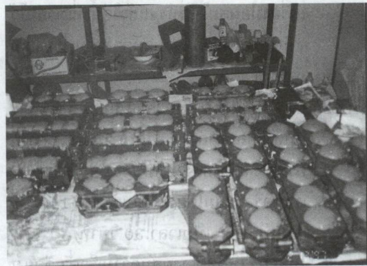
รูปที่ 2 คอนกรีตพูนเกิดการพองตัวเนื่องจาก
