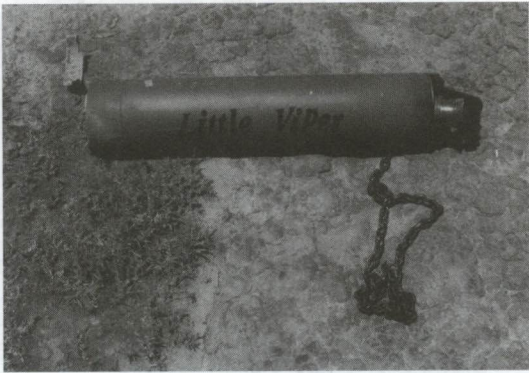
รูปที่ 3 แสดงภาพของจรวดลากระเบิดสายหลังยิง
