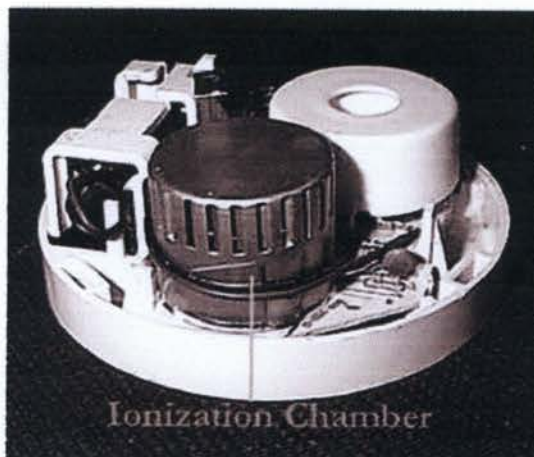
ภาพที่ 3.35 ภายในอุปกรณ์ตรวจจับควันชนิด ไอออไนเซชัน (Smoke Detector Ionization Type)
