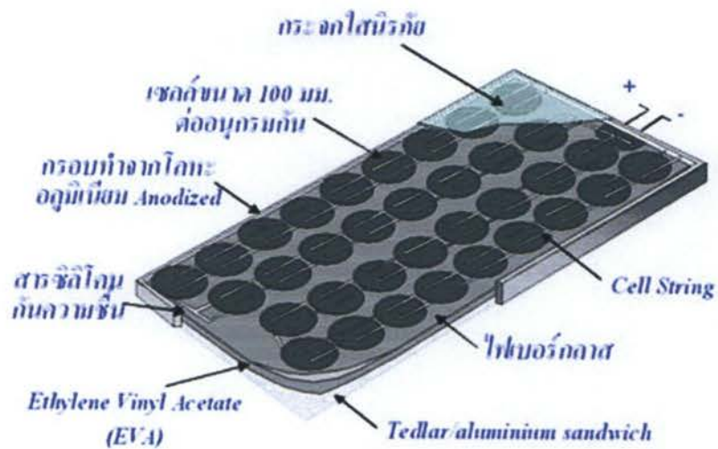
ภาพที่ 2.6 แสดงส่วนประกอบของ Solar Cell
