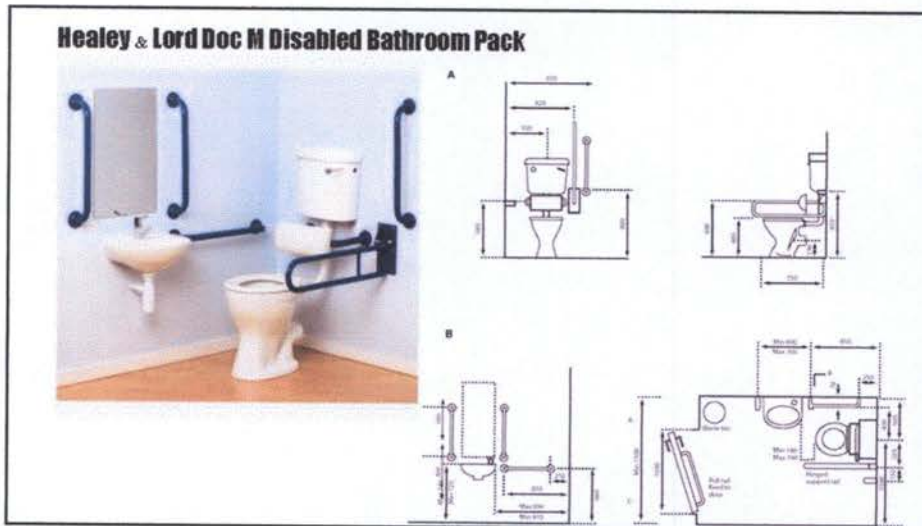
ภาพที่ 2.17 : แสดงการติดตั้งราวจับ
