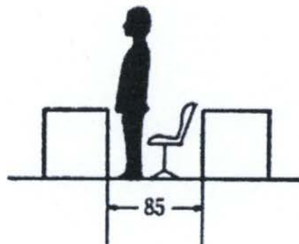
ภาพที่ 2.5 การจัดวางโต๊ะทำงานเรียงกันแบบแถวตอนและหันหน้าไปทางเดียวกัน
