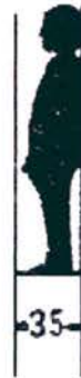
รูปที่ 2.13 ช่องว่างระหว่างผนังกำแพงที่คนตะแคงตัวเดินได้
