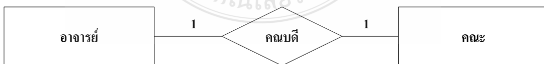
รูปที่ 2.16 ความสัมพันธ์แบบหนึ่งต่อหนึ่ง
