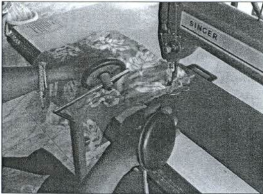
รูปที่ 11 แสดงการเข็บของคณพิการ โปลิโอ ใช่มือในการออกแรงเข็บ
