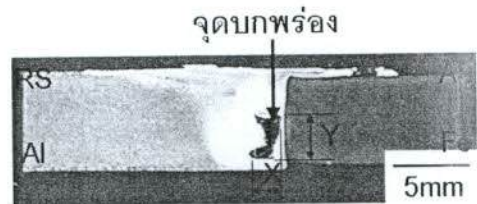
(ก) โครงสร้างมหภาคแสดงจุดบกพร่อง
