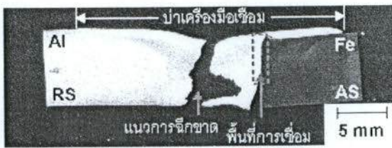
(ก) ทรงกระบอก ความเร็วเดินแนวเชื่อม 100 mm/min
