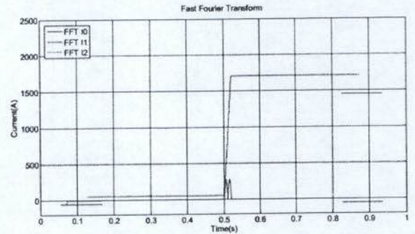
รูปที่ 4 องค์ประกอบสมมาตรของสัญญาณกระแสของเทคนิค FFT เมื่อเกิดความผิดปกติแบบ 3 เฟส
