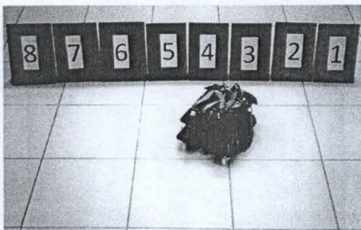
รูปที่ 17 หุ่นยนต์หยุดและถอยหลังแล้วเคลื่อนที่ออกทางขวา
